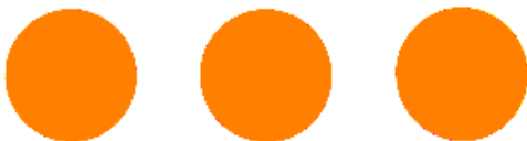
Fig. 5: Signo internacional especial para las obras e instalaciones que contienen fuerzas peligrosas
